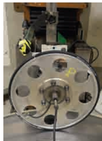
De meetopstelling voor de rolweerstand. Goed te zien: slang met luchtaanvoer.
